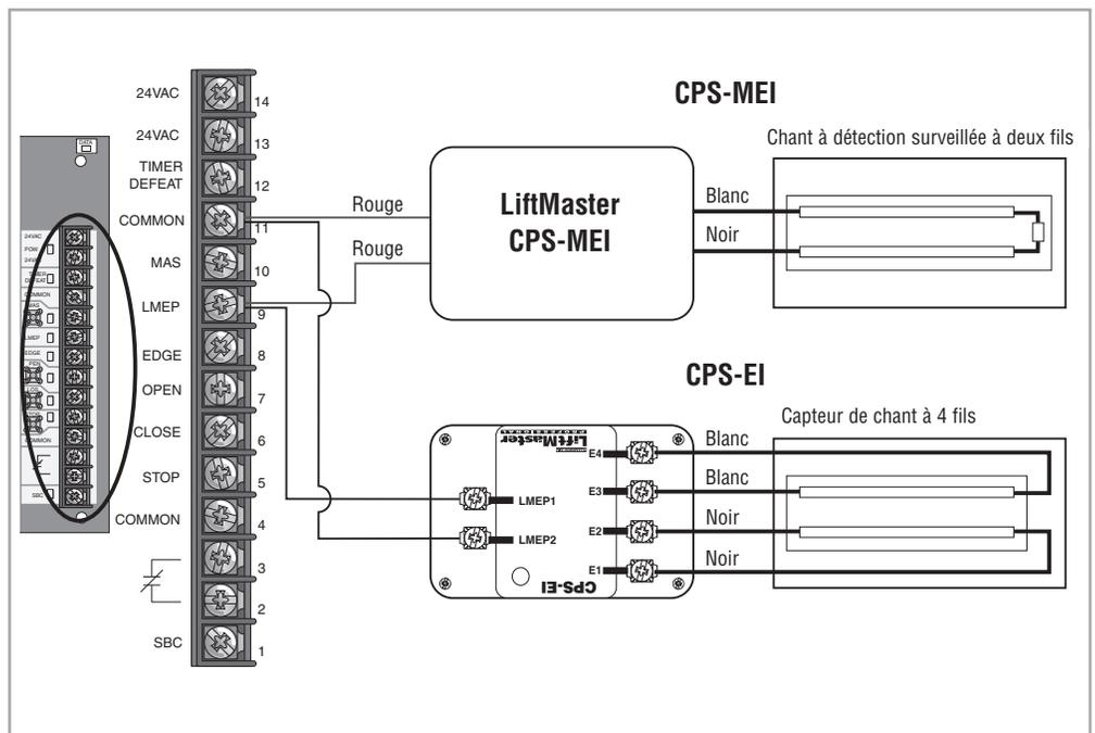
**REMARQUE :** Un seul dispositif de protection contre le piégeage peut être relié à la carte logique. Une carte CPS3CARD (facultative) est requise pour brancher un dispositif LMEP supplémentaire. Des dispositifs de protection contre le piégeage secondaires (non contrôlés et sans contact sec) seront branchés aux terminaux câblés aux capteurs d'ARÊTE et aux terminaux PARTAGÉS.
